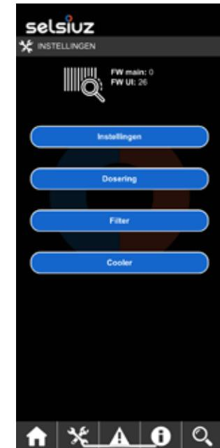
**1.** Schakel de Bluetooth functie van uw telefoon/tablet in en open de selsiuz App. Houdt de telefoon of tablet dichtbij de cooler om verbinding te maken. De knop wordt blauw als de verbinding tot stand is gekomen. Druk op verbind.
